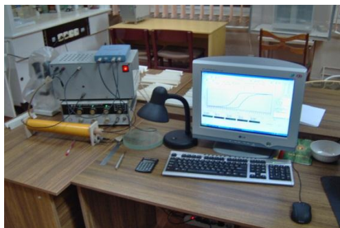
Instalație pentru măsurarea forței coercitive și determinarea curbelor de magnetizare a probelor filiforme
